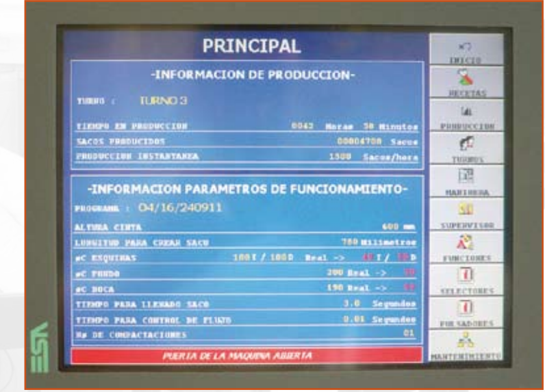
Pantalla de control de producción Touch-Screen for output control
