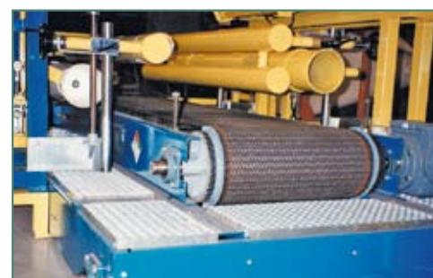
Cinta de malla con sistema de recogida de producto Steel mesh conveyor with product recovery system
