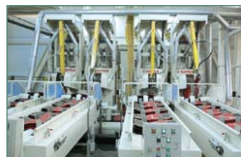
Instalación en línea (4 unidades), con almacenes múltiples In-line installation (4 units) with multiple empty bags tray
