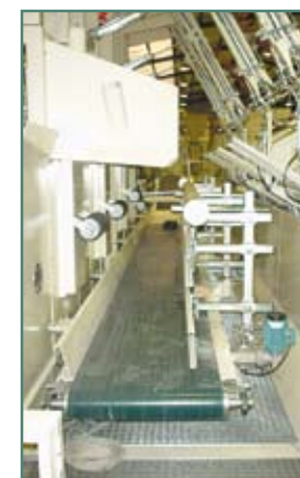
Ajustes motorizados de caída de sacos Motorised adjustment for bags falling
