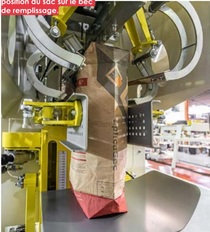
Installation à haute cadence : 4 ensacheuses à valve PFG-10 fonctionnant en ligne. Production jusqu'à : 2 200 sacs / heure
