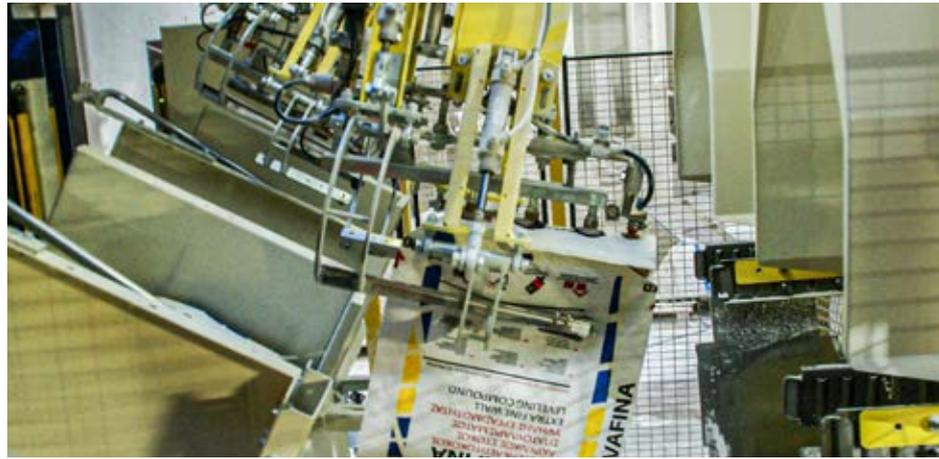
matiques de la série PFG-10 équipées du système de soudure par ultrasons « STV ». Cette nouvelle ligne sera modernisée à l'avenir avec l'ajout d'un troisième bec de remplissage supplémentaire. Elle peut actuellement produire 600 sacs par heure avec un système de soudure à valve, et 700 sacs par heure sans ce système. Lors de l'ajout d'un troisième bec de remplissage, elle aura alors une capacité de 900 sacs par heure avec un système de soudure à valve, et de 1 050 sacs par heure sans ce système.
