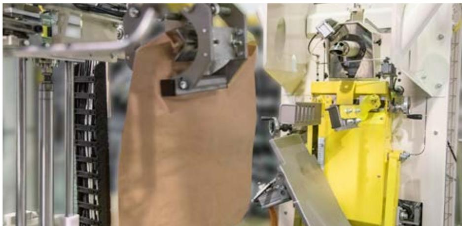
Il a maintenant installé un ALL-IN-ONE avec un seul bec d'ensachage et une palettisation intégrée. Les sacs de 25 kg sont remplis, scellés et palettisés avec ce robot très peu encombrant (4 m x 6 m). L'opérateur remplit le magasin de sacs vides et collecte les palettes chargées pour les expédier.
