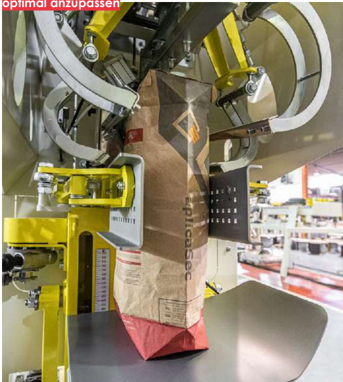
Höheneinstellung um die Säcke an den Füllstutzen optimal anzupassen
