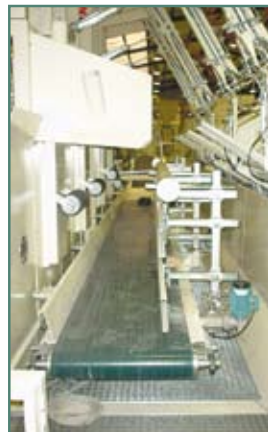
Ajustes motorizados de caída de sacos Motorised adjustment for bags falling
